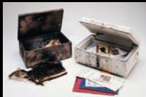
非耐火製品(左)と セントリー耐火保管庫(右)の耐火実験後
