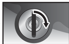
②補助キーを軽く前方に押しながら、右に1/4回転させます
