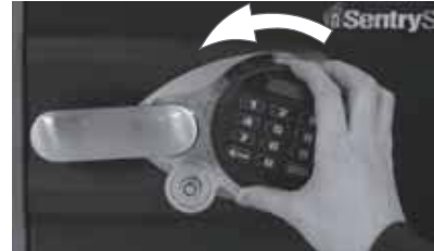
④配線コードの巻き込みに注意し、テンキーパネルを左に回し元に戻してください。
