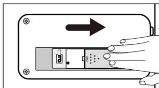
①扉を開け、ドア裏の電池ケースカバーを取り外します。
