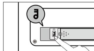
②電池ケース内の左側にある「3」ボタンを押します。「ピーピー」と2回ピープ音が鳴ります。
