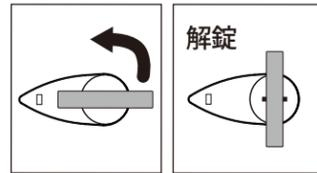
②強制解錠キーを鍵穴に挿入し、左へ90度回します。
