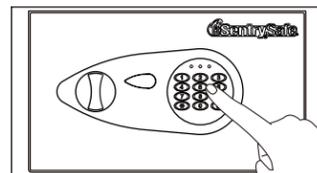
③登録する暗証番号（2～8桁）を順に押し、最後に「#」キーを押します。「ピーピー」とピープ音が2回鳴り、新しい暗証番号が設定・保存されます。
