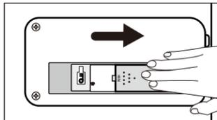
①扉を開け、ドア裏にある電池ケースカバーを右にスライドさせて取り外します。
