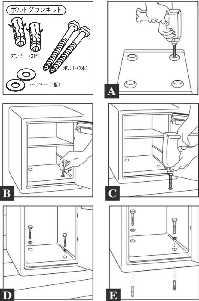
1. 金庫の扉を上にして横に倒してください。金庫の底の2角(対角)に凹みがあります。11mmのドリル・ビットを使い、金庫の底に垂直にドリルをあてて2つの凹みに穴を開けてください。(図A)
