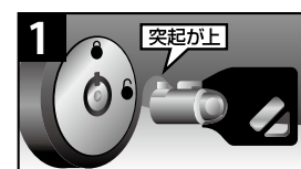
1 突起が上 補助キーを突起のある方を上にし、鍵穴に挿入します。
