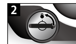
2 補助キーを軽く前方に押しながら、左に1/4回転させます。
